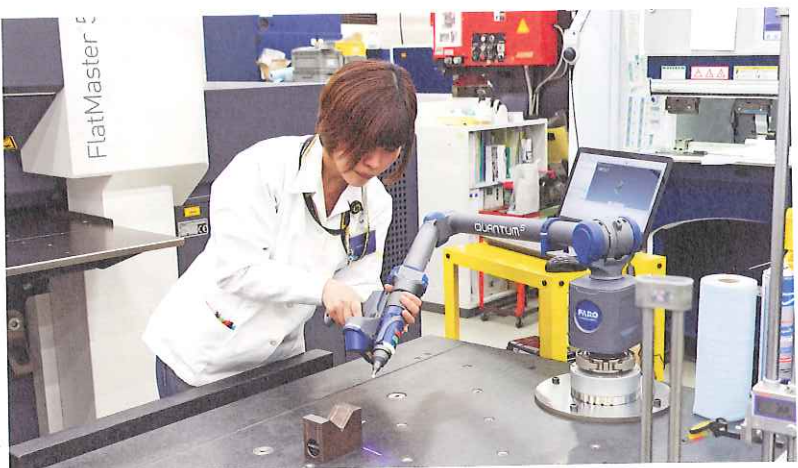
馴れた手つきで3次元のレーザー測定器を操る女性社員
