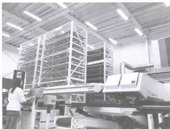
写真1 自動倉庫（全自動材料棚）とレーザ・パンチ複合機の組み合わせ
